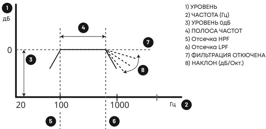
Использование отсечки HPF (Фильтр верхних частот) или LPF (Фильтр нижних частот) дает вам возможность установить частотный диапазон для каждого линейного выхода.
