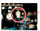
Über Potentiometer (roter Kreis) kann die Empfindlichkeit der Signalerkennung stufenlos eingestellt werden.
